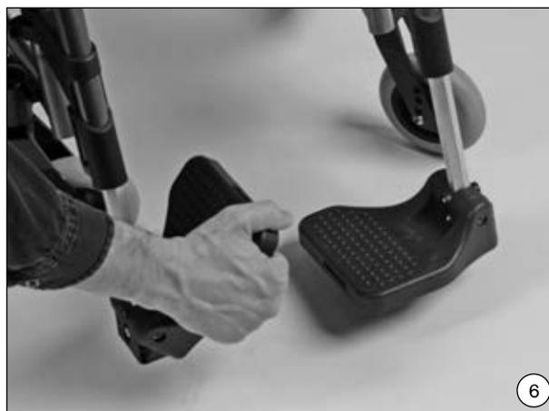
**⚠ VORSICHT Unfallgefahr.** Achten Sie bitte bei der Montage auf die sichere Arretierung der Steckachse in der Aufnahmebuchse! Bei nicht gedrücktem Knopf darf sich das Antriebsrad nicht entfernen lassen!
