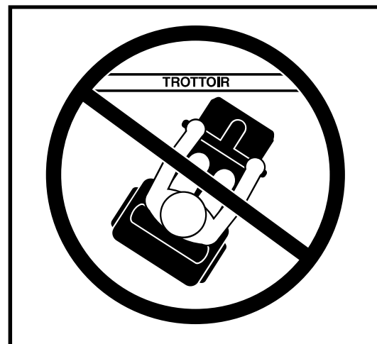
Figure 7. Approche incorrecte de trottoir
