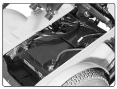
Fig. 36. Batteries
